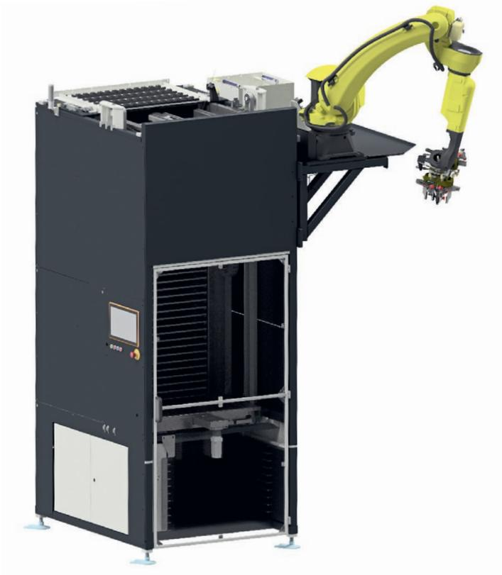
Für bessere Zugänglichkeit an der Maschine bietet diese kompakte Automatisierung mit Beladung von oben eine dezente Lösung mit grossem Speicher. Besonders an Werkzeugmaschinen mit rotierendem Werkstück bringt das RoboLift-Konzept Vorteile.
